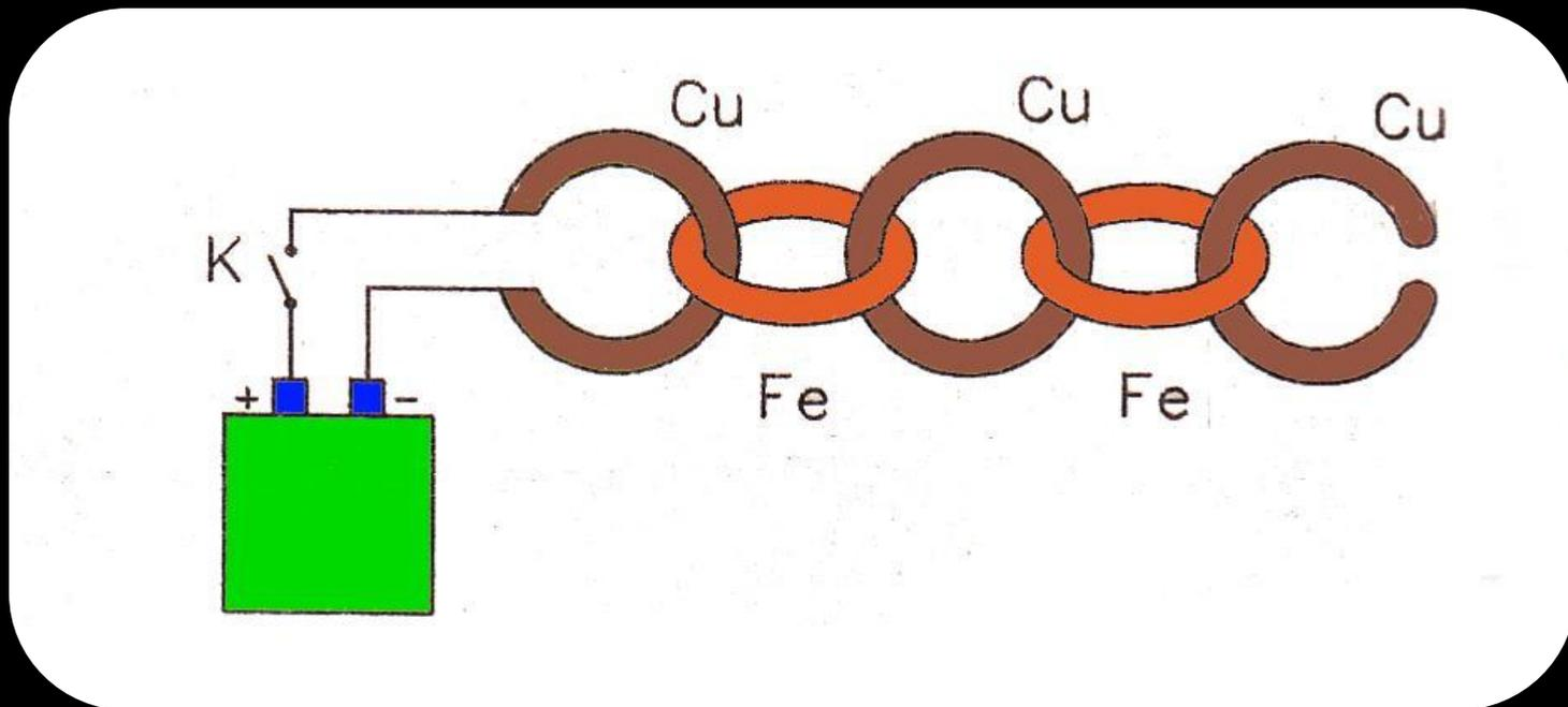
Замыкая на мгновение ключ  $K$ , мы посылаем ток от батареи в первое медное кольцо. Следующее кольцо, сделанное из железа, намагничивается. Возникновение в нем магнитного поля вызывая индукционный ток в третьем кольце. Этот ток вызовет магнитное поле в четвертом и т.д.
