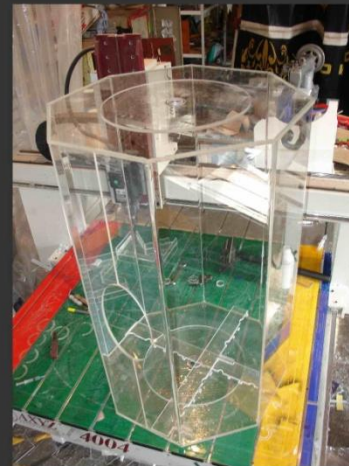
Процесс изготовления лототрона материал: акрил 10 мм обработка: фрезер, термогиб, акриловая сварка размер: 1300 x 800 мм
