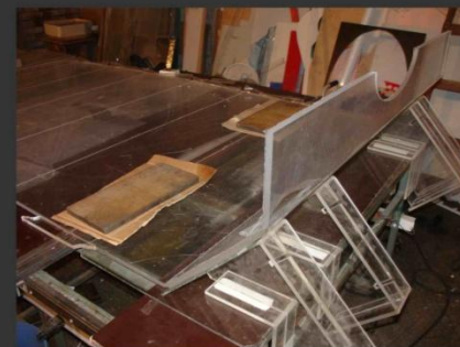
Процесс изготовления лототрона материал: акрил 10 мм обработка: фрезер, термогиб, акриловая сварка размер: 1300 x 800 мм
