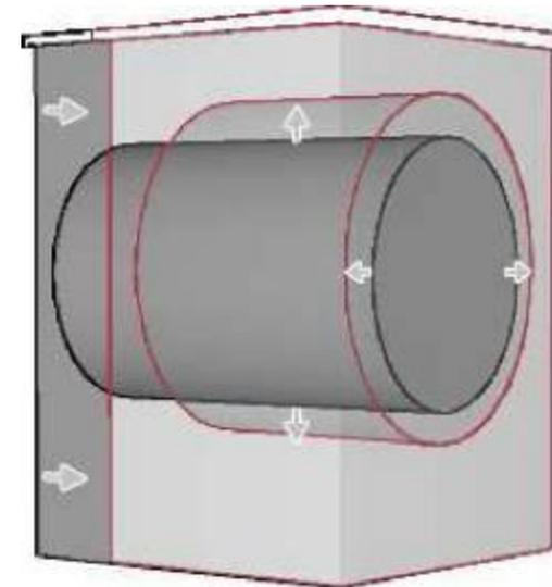
**Увеличенный диаметр и объем барабана, позволяет достичь такого же количества загружаемого белья, но при более узких размерах.**
