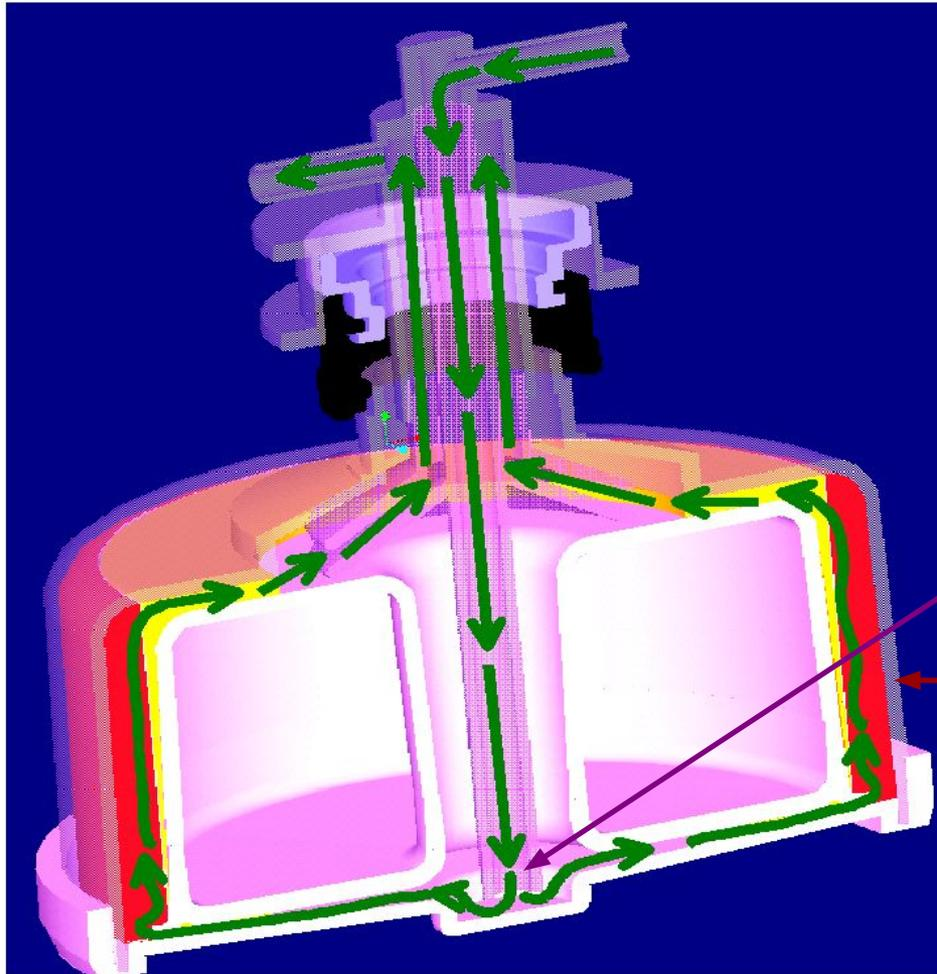
*Заметьте: отражатель потока на основании перегородки направляет промывающий раствор непосредственно на слой эритроцитов*
