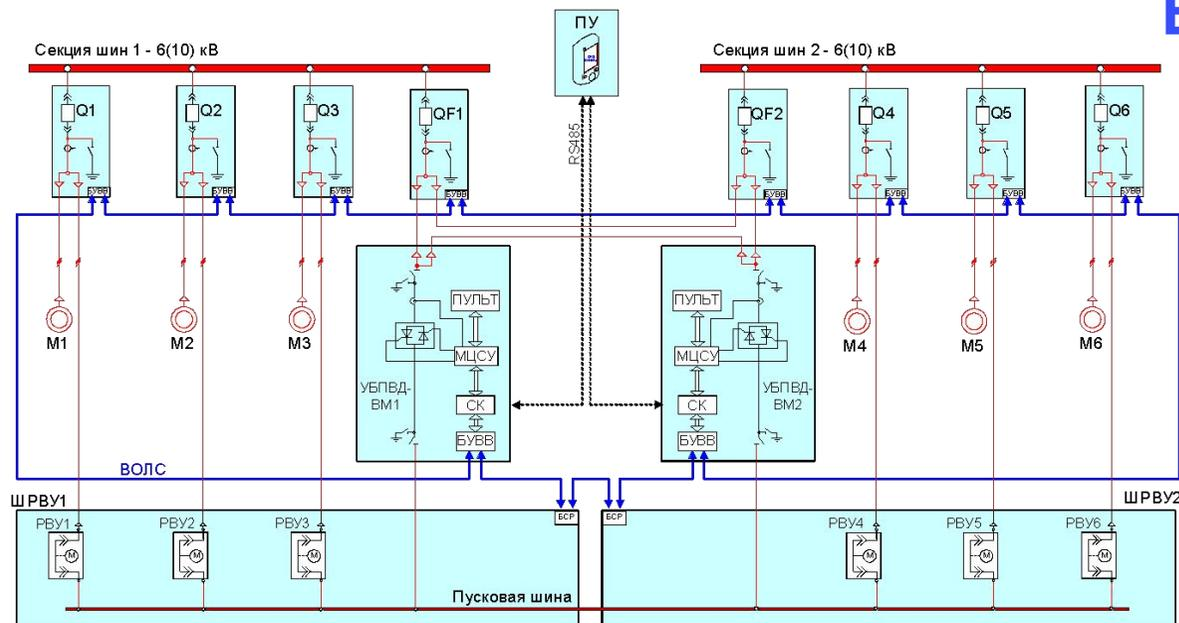
**Краткое описание:** 2 устройства плавного пуска для поочередного плавного пуска и останова 6 агрегатов. 100% резервирование. Сигналы управления передаются по оптоволоконным линиям связи.
