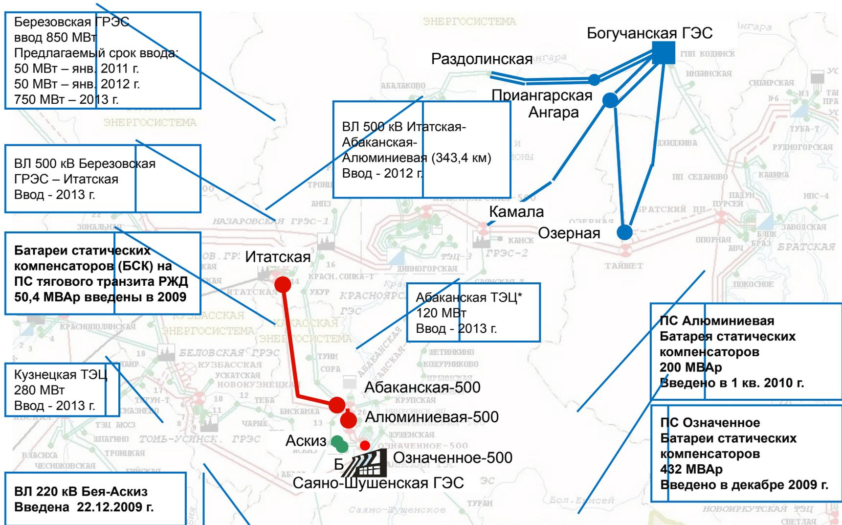
\* Ставится турбина Т-200, с увеличением располагаемой мощности станции на 120 МВт.
