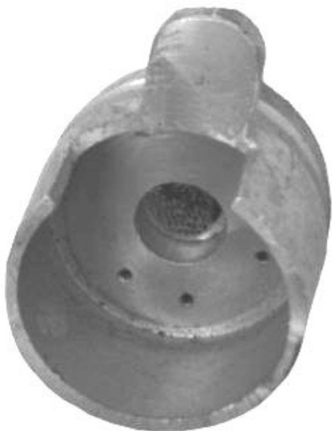
Корпус (крышка) механизм включения делителя КАМАЗ
