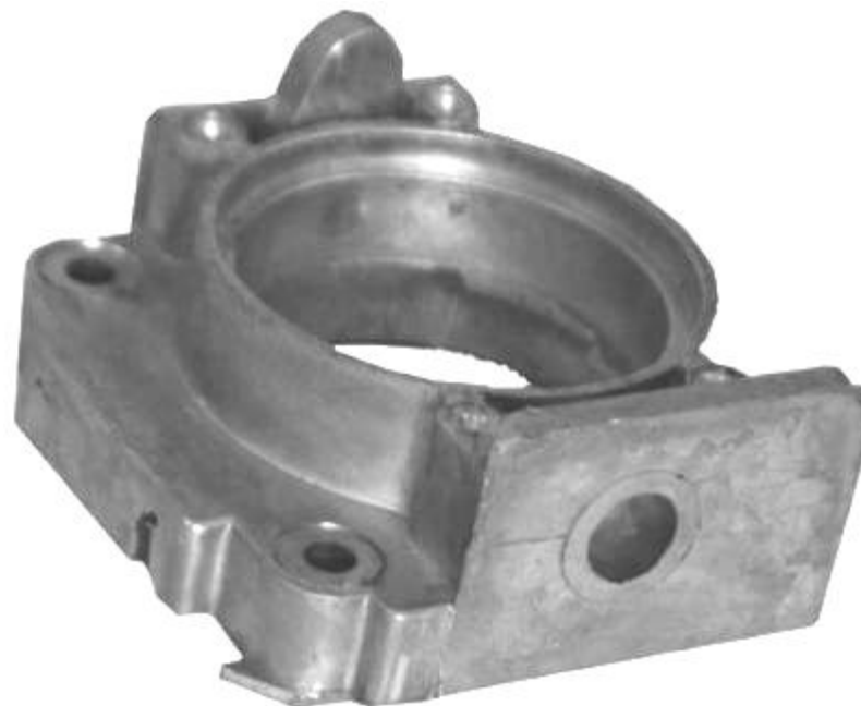
Основание корпуса ИЮАШ 31414015 система приготовления смеси автомобилей Газель
