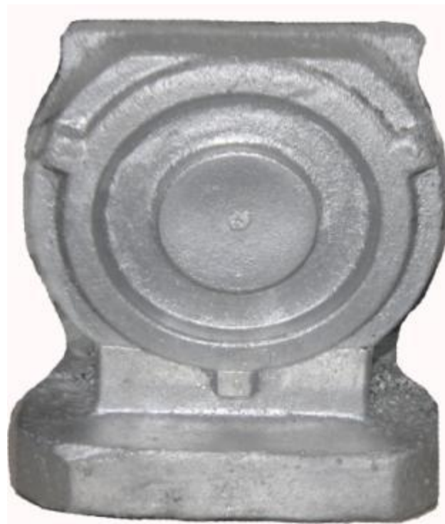
Корпус НТ8.020.022 вакуумный насос
