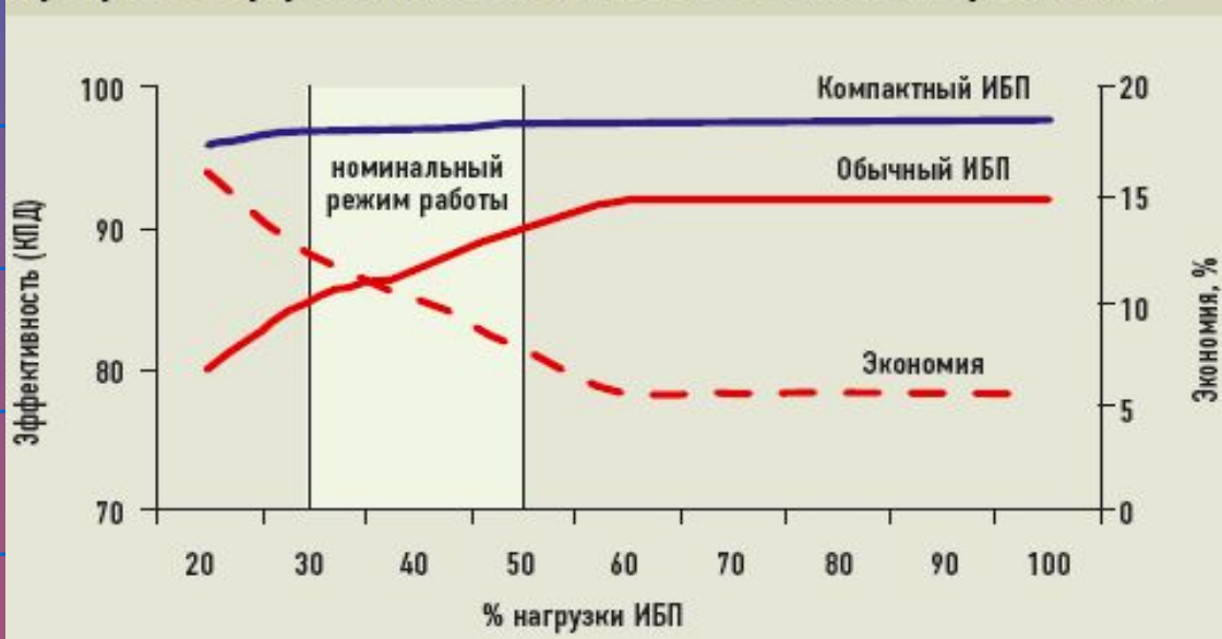
Профиль эффективности использования энергии ИБП
