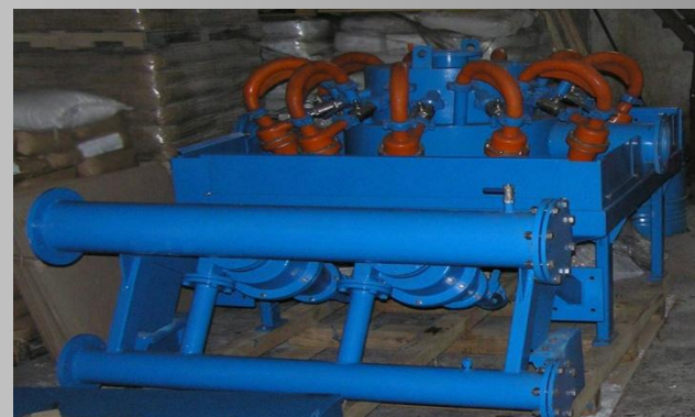
очиститель бурового раствора
