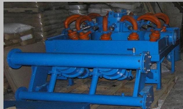
очиститель бурового раствора
