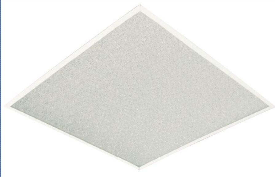
**Светодиодный светильник предназначен для общего освещения общественных зданий, административных, офисных и иных помещений . Светильник встраивается в подвесные потолки типа Армстронг (со стандартным модулем 600x600 мм). Является экономичной заменой светильника ДВО 4x18 с люминесцентными лампами**
