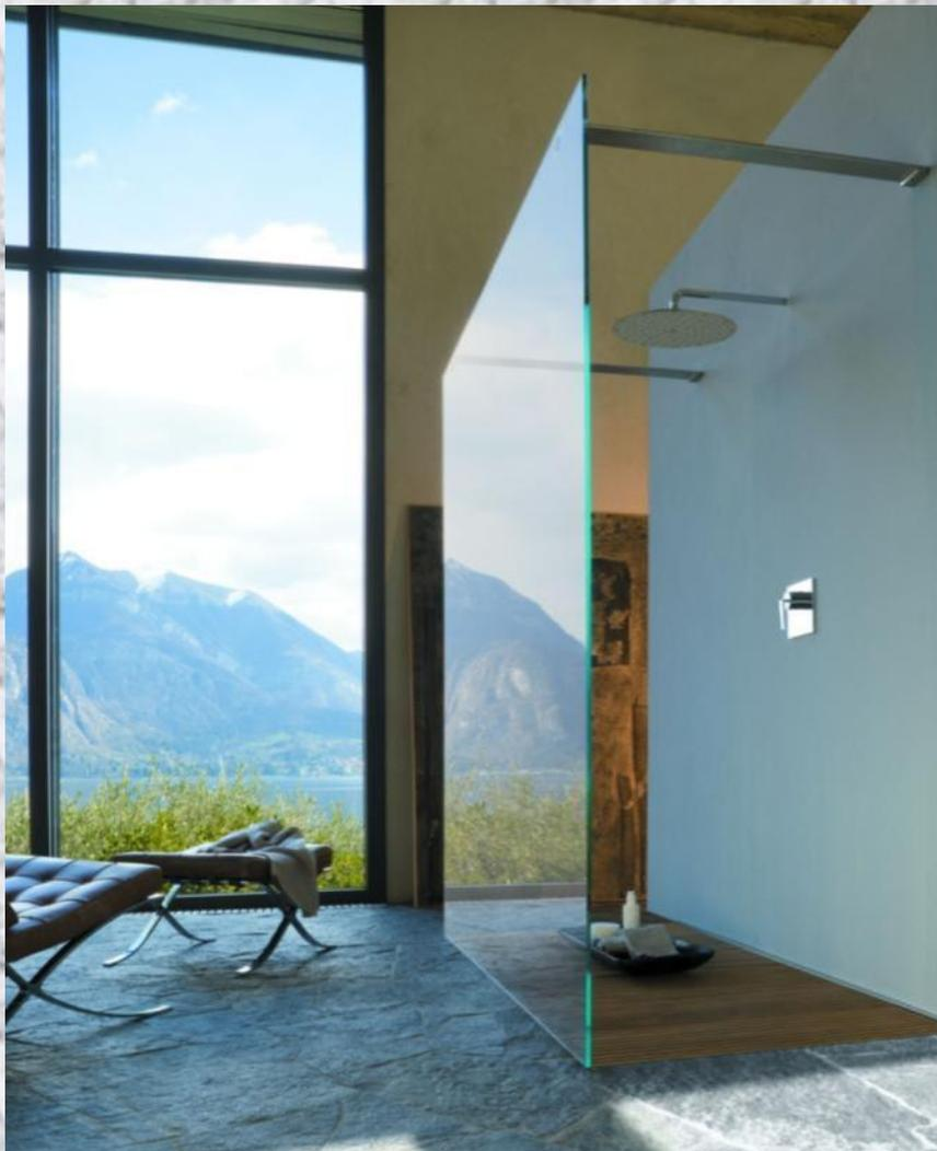
Серия Plano отличается высококачественным экстра прозрачным стеклом толщиной в 8 мм, надёжными крепежами, короткими сроками изготовления. Максимально возможный размер единого стеклянного полотна – 180\*200h
