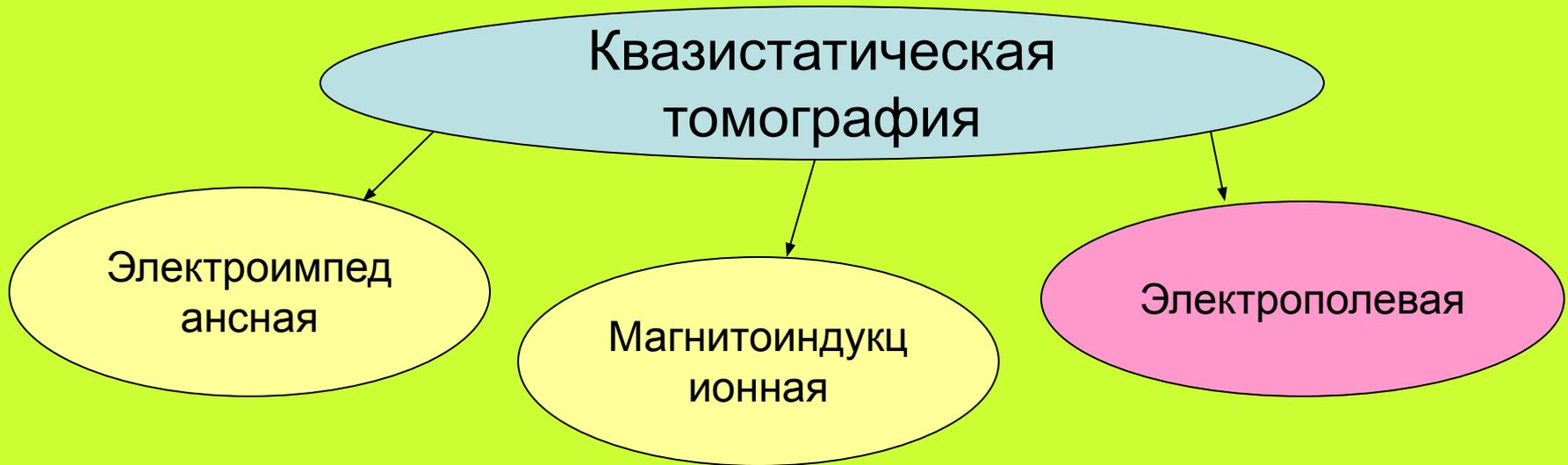
**Электрополевая томография** - новое направление в квазистатической томографии, которое позволит получать изображение пространственного распределения электрических свойств объектов бесконтактно, используя взаимодействие с ними радиочастотного электрического поля.
