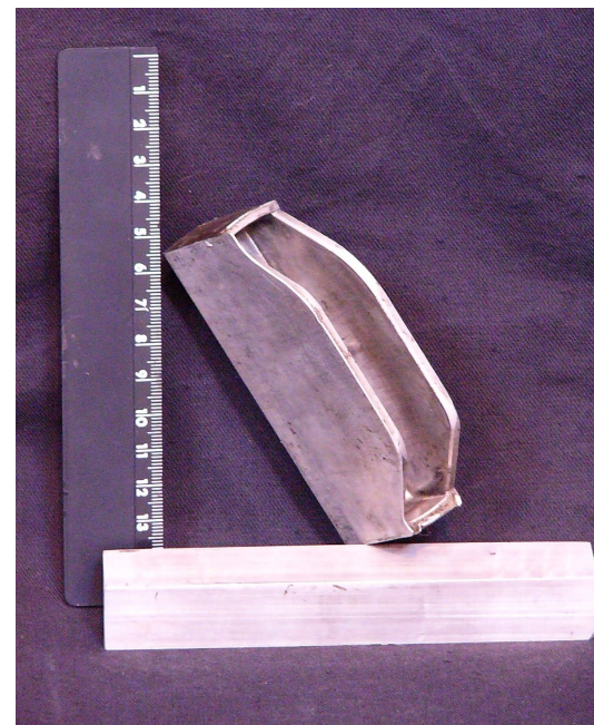
Изделие из нанокристаллического магниевого сплава MA14. Скорость штамповки - 1 мм/с, температура штамповки - 240 °С
