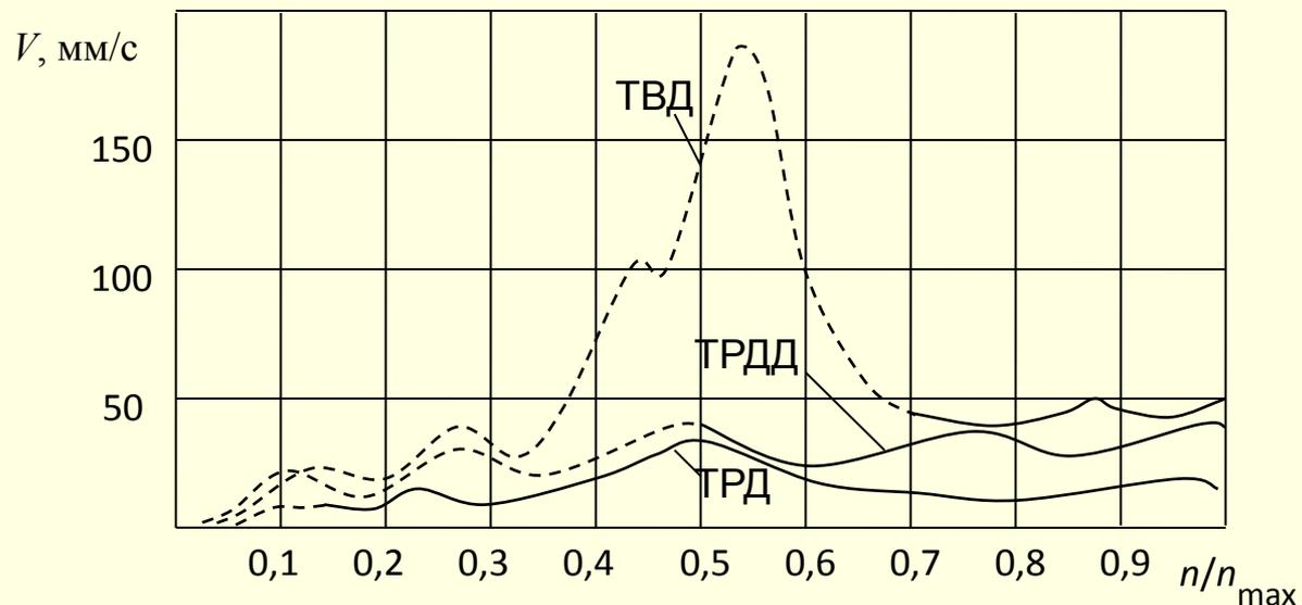
Изменение роторной виброскорости двигателей самолетов при изменении частоты вращения ротора: - - - в процессе пуска; — на рабочих режимах
