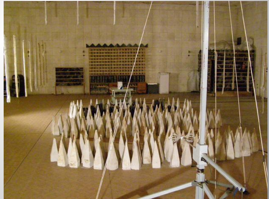
Радиоэкранированный зал (24x24x6 м)
