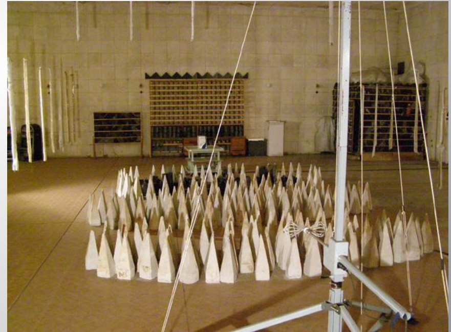
Радиоэкранированный зал (24x24x6 м)
