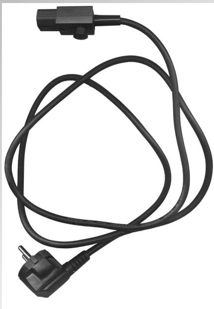
Одно из таких устройств - специальный шнур сетевого питания **"Сигнал"** со встроенной в розетку шнура электронной схемой, которая звуковым сигналом извещает пользователя ПЭВМ об отсутствии (исчезновении) заземления и, следовательно, об ухудшении электромагнитной обстановки на рабочем месте
