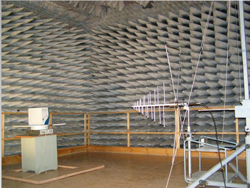
Безэховая электромагнитная камера (9x9x6 м)
