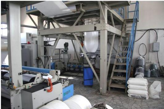
На первой стадии из гранулированного сырья производится прозрачная, белая или цветная (в зависимости от добавок) пленка. Машина, осуществляющая производство пленки из гранул называется **Экструдер**.
