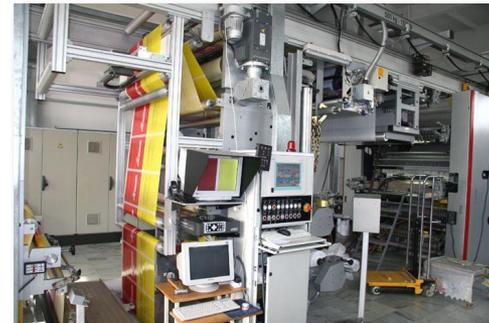
По завершении второй стадии получаются рулоны пленки с нанесенным на нее рисунком. Далее из этих рулонов производится полиэтиленовый пакет. В зависимости от типа пакета (майка, пакет с прорубной ручкой) данную работу выполняют **Машины для резки**. Они же осуществляют вырубку ручек и, если необходимо, их укрепление (для пакетов с прорубной ручкой).
