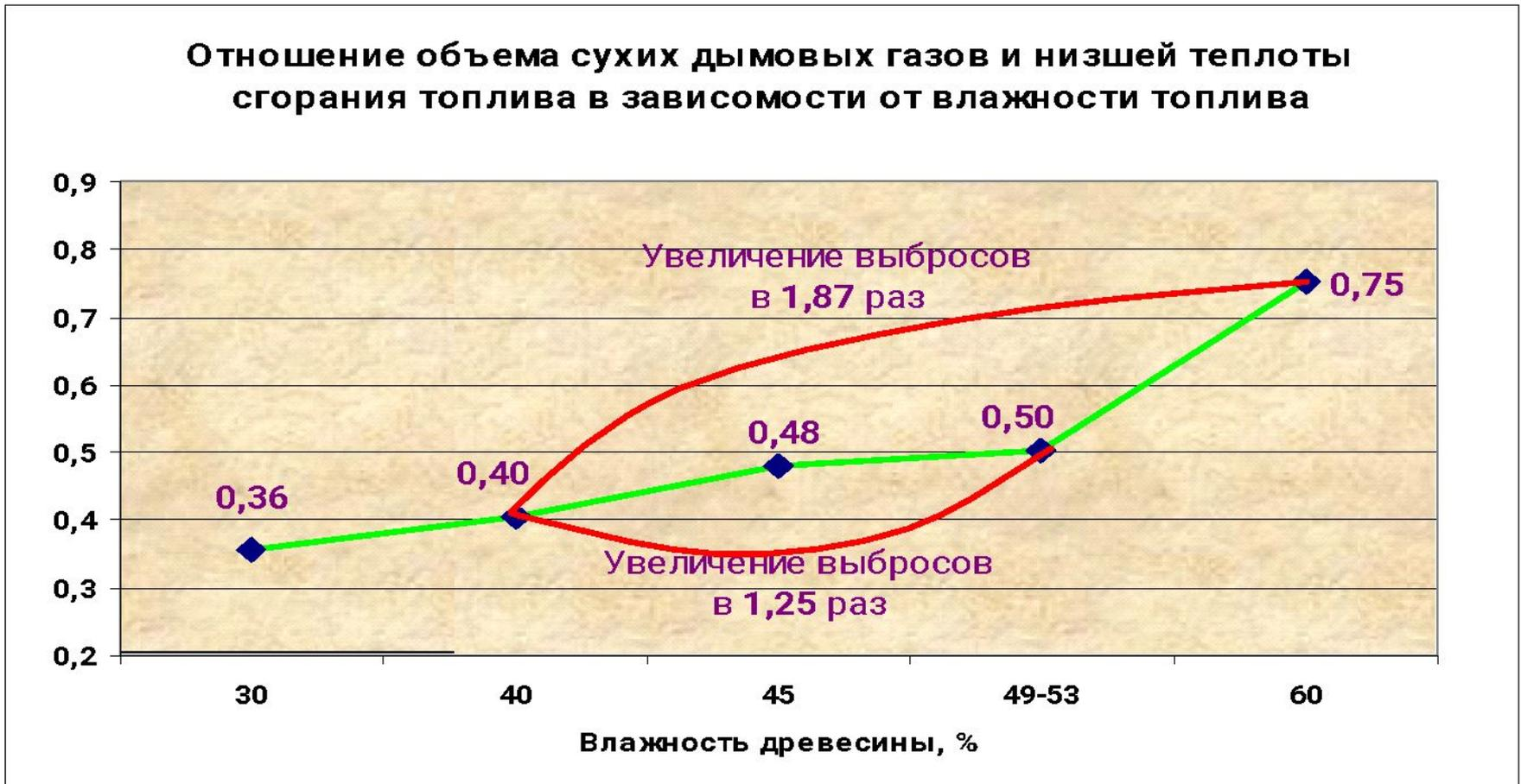
Рассмотрим подробнее, каким образом влажность топлива влияет на коэффициент полезного действия котла. Данную зависимость иллюстрирует следующий график, который показывает уменьшение КПД «брутто» котла при увеличении влажности топлива
