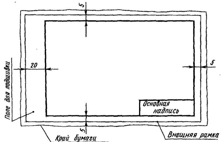
Формат с размерами сторон 1189x841 мм, площадь которого равна 1м<sup>2</sup>, и другие форматы, получаемые путем последовательного деления его на две равные части, параллельно меньшей стороне соответствующего формата, принимаются за основные.
