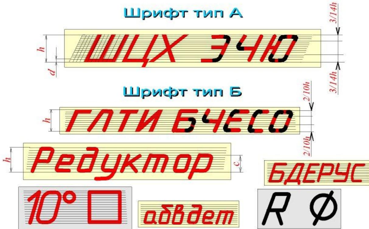
Шрифты выполняют при помощи вспомогательной сетки, образованной тонкими линиями, в которую вписывают буквы. Шаг линий сетки определяется в зависимости от толщины линий шрифта  $d$ . Начертание шрифта типа Б приведено в таблицах.
