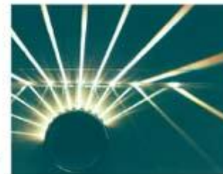
Отражение света при переходе из оптически более плотной среды в менее плотную
