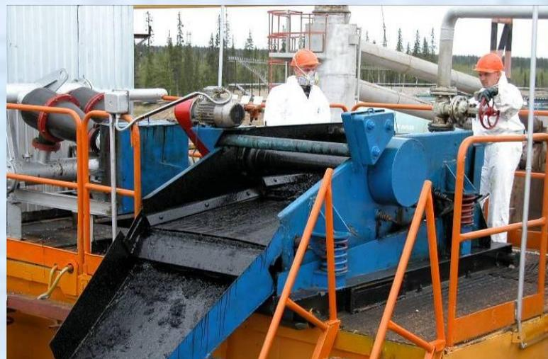
*Установка по переработке загрязненных нефтью почв и грунтов
