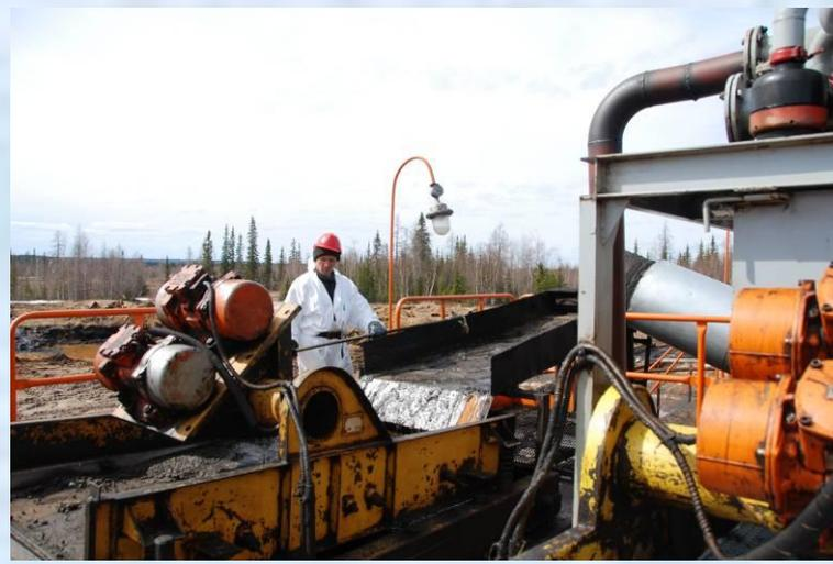
*Комплексная установка по переработке нефтяных шламов
