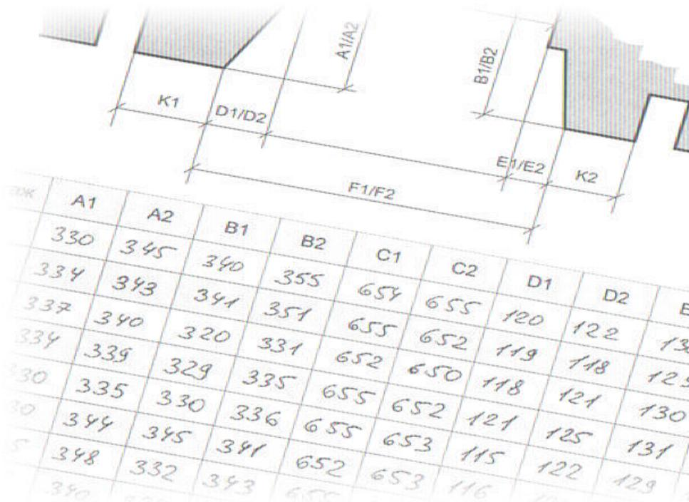
Составление размерных матриц предусматривает снятие с каждого портала не менее 18-ти размеров
