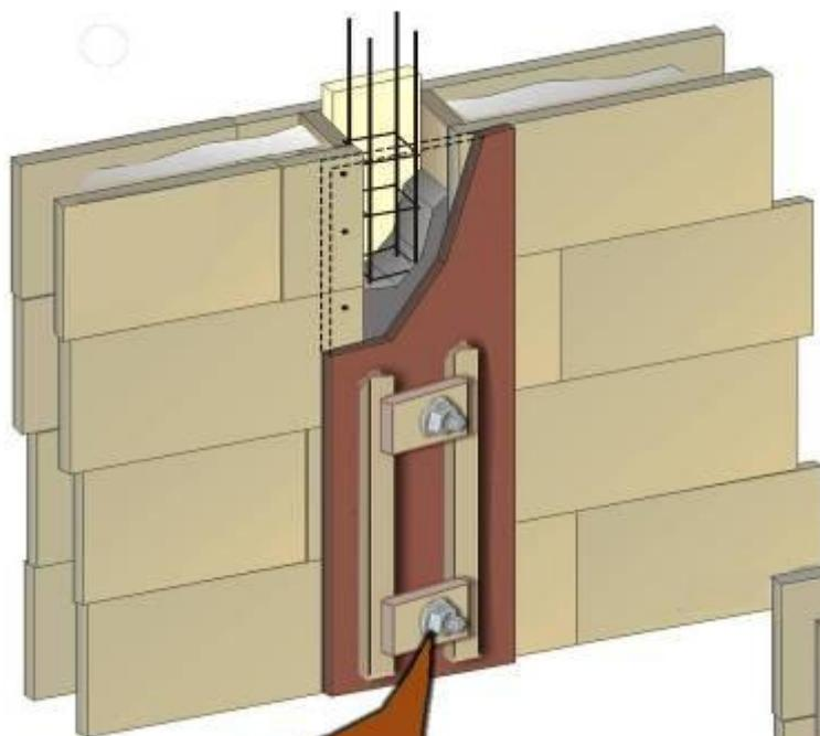
1. В нахлест установить опалубку (фанеру) изнутри стен
