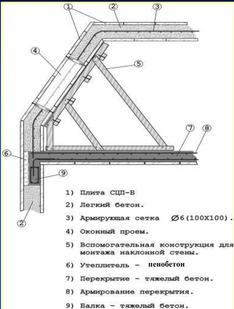
Рис.5 Сечение стены мансардного этажа
