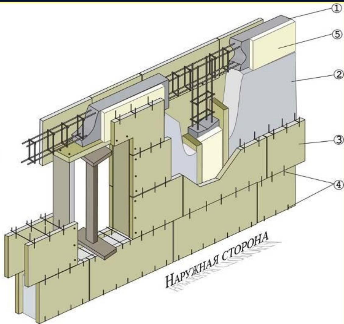
Фрагмент стены типового этажа с оконным проемом.
