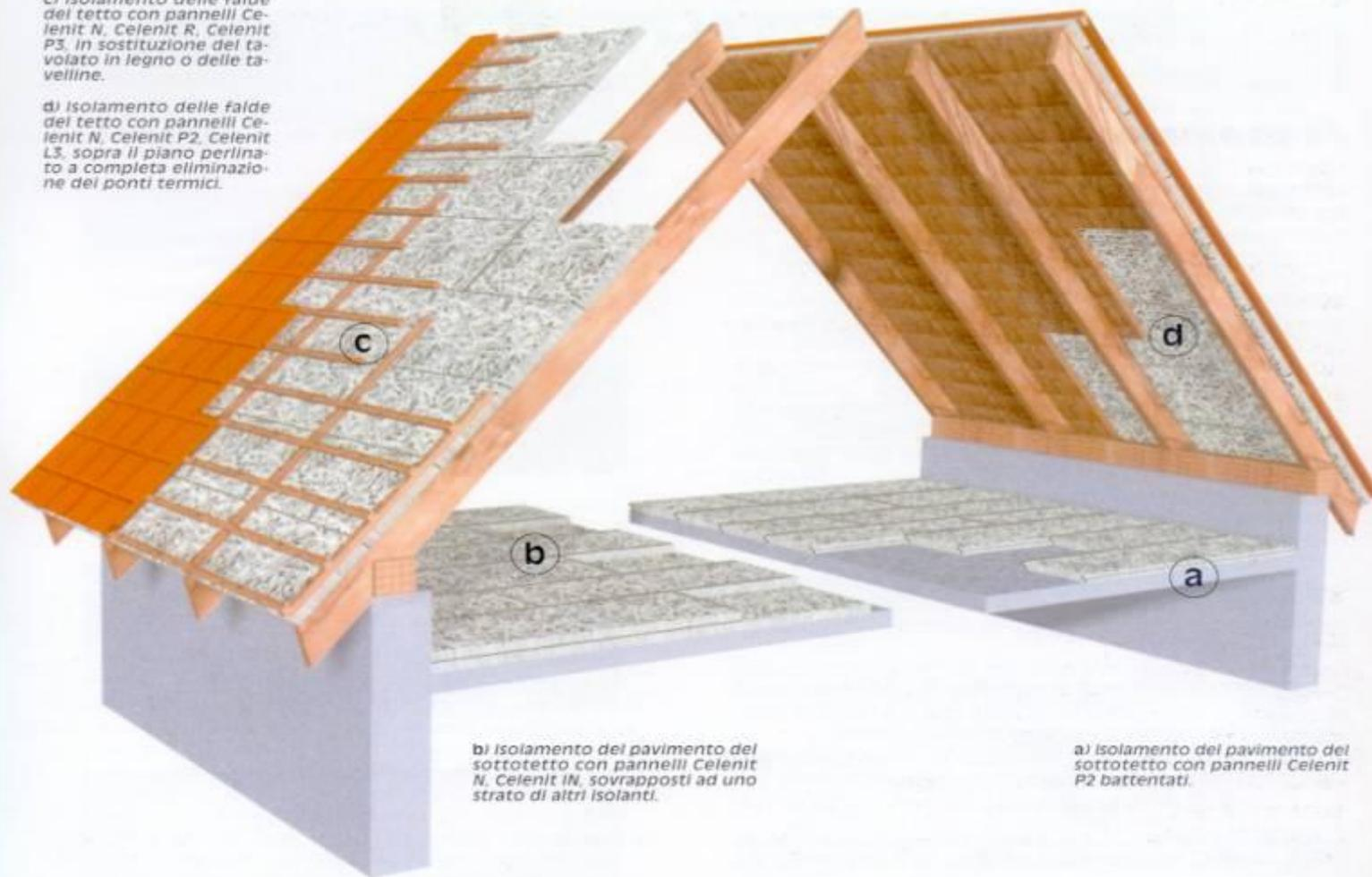
b) Isolamento del pavimento del sottotetto con pannelli Celenit N, Celenit IN, sovrapposti ad uno strato di altri isolanti.
