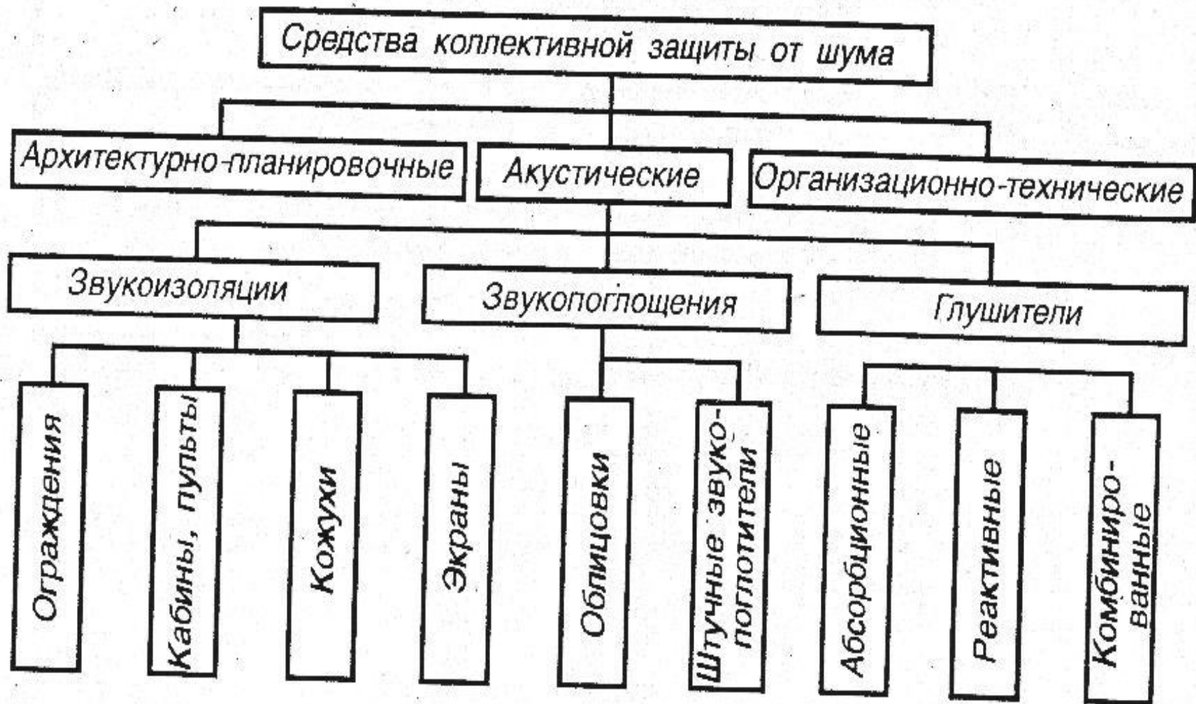
Рис. 4.24. Средства коллективной защиты от шума на пути его распространения
