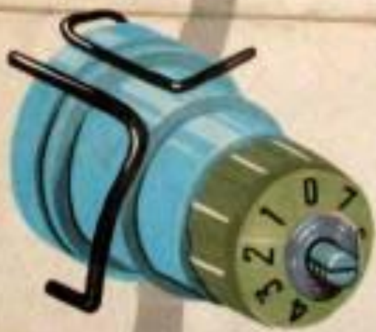
Регулятор натяжения верхней нитки машины «Чайков» ИС-I класса ПМЗ
