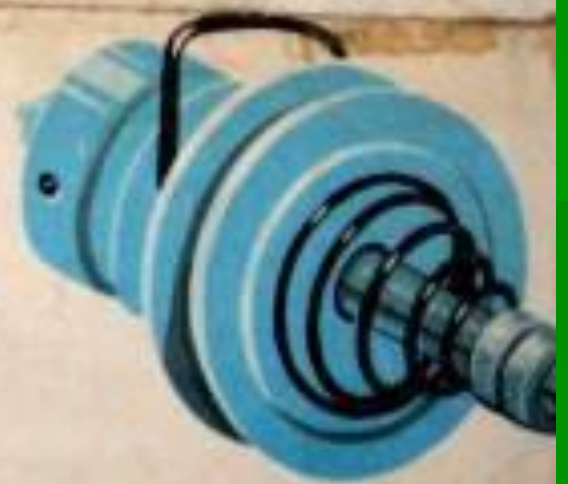
Регулятор натяжения верхней нитки машины 100-го класса ПМЗ
