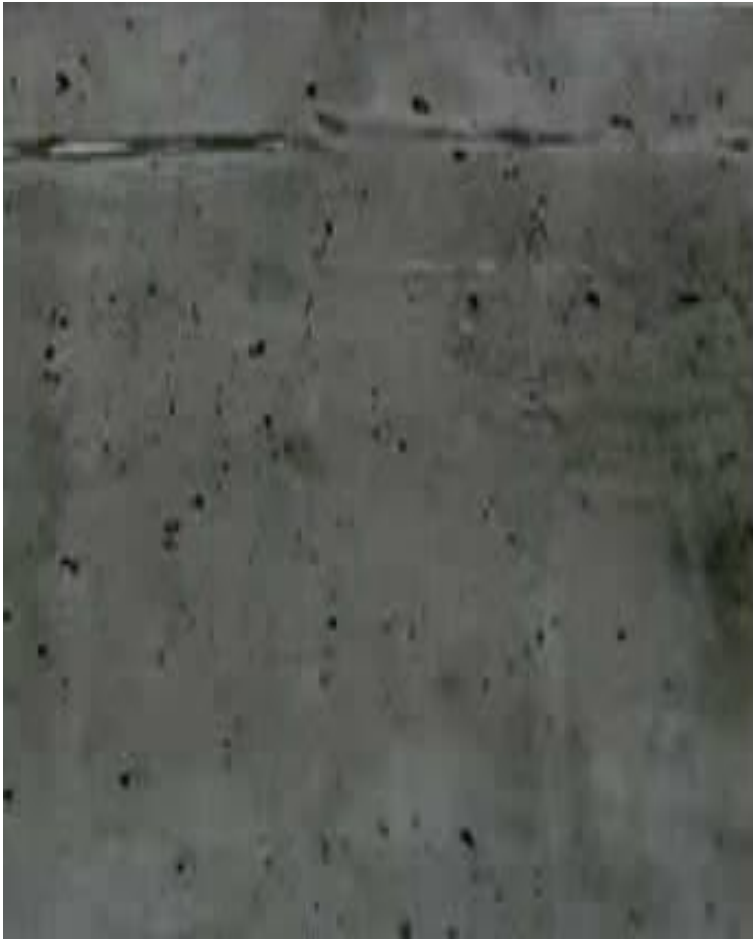
а. Железобетон после применения в качестве смазки отработанного масла
