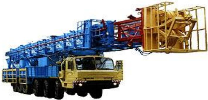
Установка предназначена для бурения ротором и забойными двигателями, освоения и восстановления нефтяных и газовых скважин.
