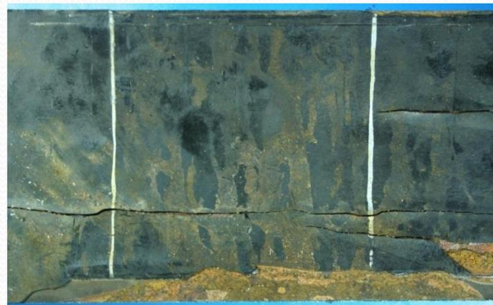
**Отслоения внутреннего покрытия Amercoat 2171 на трубе Ø530x8 мм**
