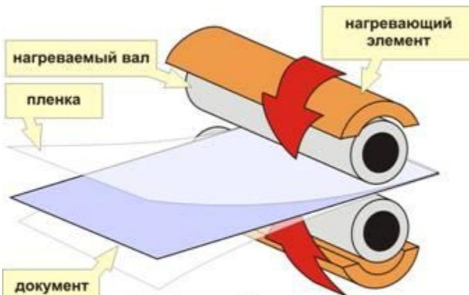
Схема работы ламинатора по технологии нагреваемых валов
