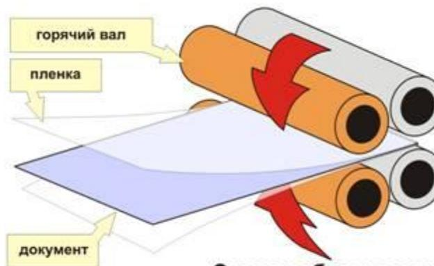
Схема работы ламинатора по технологии горячих валов
