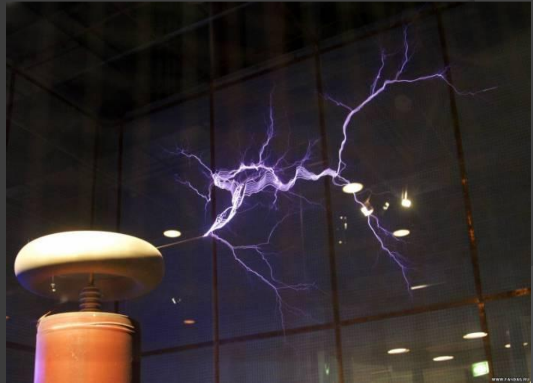
Дуговой разряд от трансформатора Теслы
