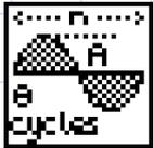
**Sine Pattern VI (Analysis >> Signal Generation palette)** - генерирует синусоидальную волну требуемой частоты (2 экземпляра).
