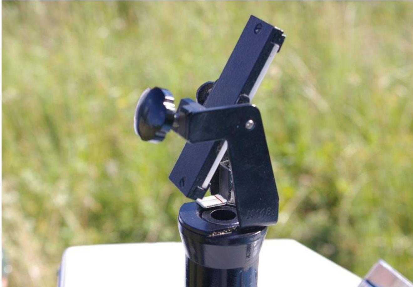
Отражательный элемент озонметра М-124
