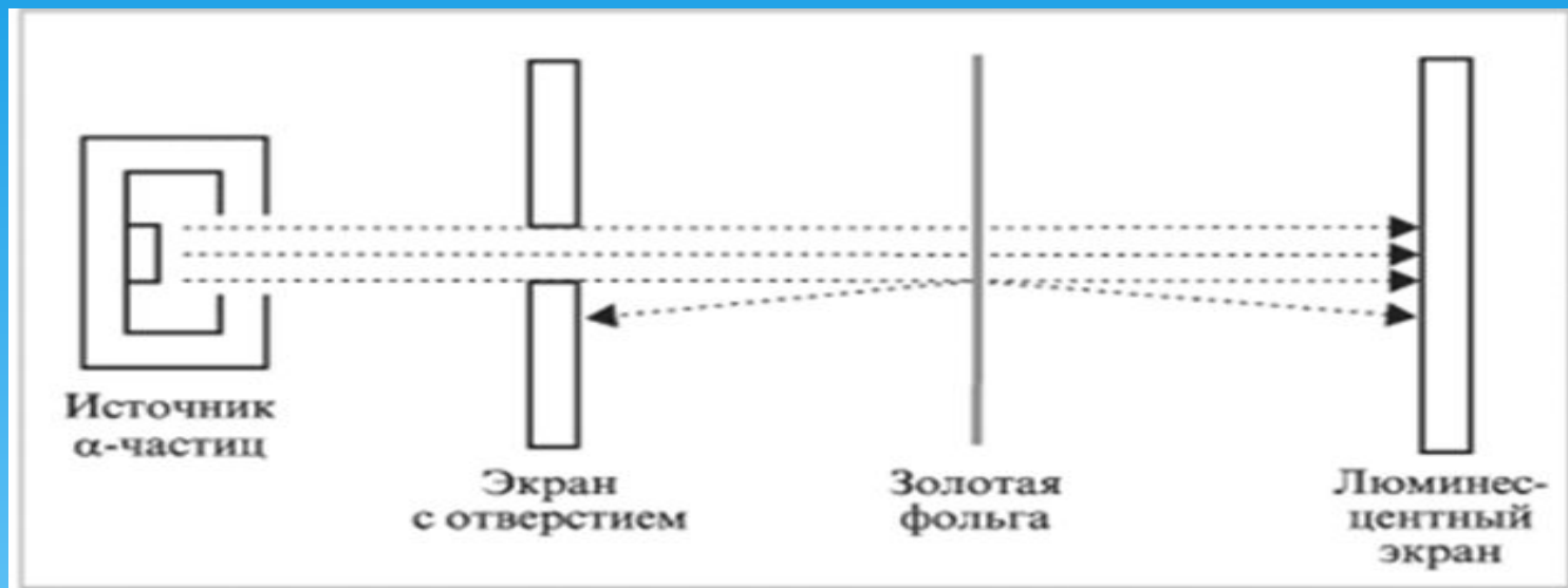
Рис. 1 Эксперимент Х.Гейгера и Э.Марсдена
