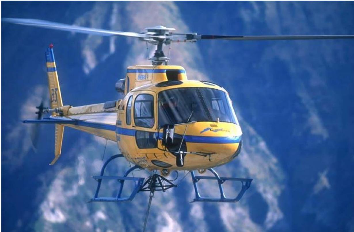
*Eurocopter AS350 B3 — легкий однодвигательный вертолет, отличающийся превосходными летно-техническими характеристиками, безопасностью полетов и низкими эксплуатационными расходами.*
