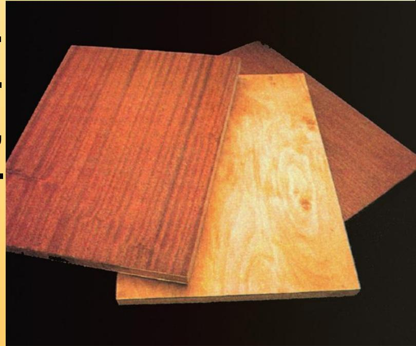
На рисунке показано движение волокон в покровных слоях и в лущённых пластинах, заполняющих сердцевину плиты.
