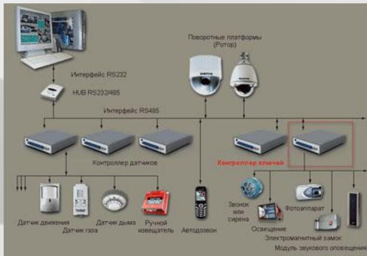
GOAL v9 имеет **объектно-ориентированную модель** построения. Каждая единица оборудования, подключенного к системе, будь то видеочамера, микрофон, датчик или исполнительный механизм, является в системе отдельным объектом с определенным набором свойств и настраиваемых параметров, отражающих особенности реального оборудования.
