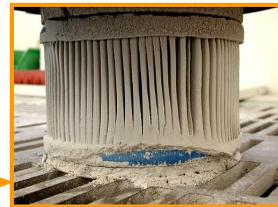
Просто закройте подключение или шланг и нажмите на кнопку **Push&Clean**. **Сильные потоки воздуха мягко очистят фильтр.**
