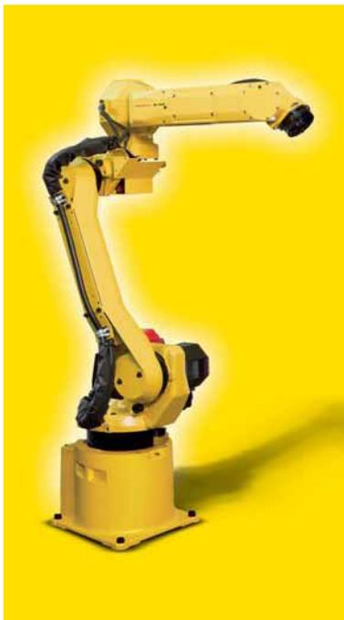
В августе 2010 г. **ООО «Фактор спецэлектроника»** внедрило в производственный процесс **«жёлтого помощника»** - шестиосевого промышленного робота **FANUC M100iA/6L**. В настоящее время робот планируется применяться на операциях извлечения деталей из термопластавтомата, удаление летников, и укладывания в тару.
