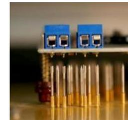
Внутрисхемный контроль обеспечивается комплексом оборудования собственной конструкции, состоящим из прижимной системы от **Ingun** и электронного тестера **ChekSum**. Для каждого вида электронных плат изготовлена система, состоящая из игольчатых пробников от **Ingun**. При обнаружении неисправности система сообщает о том, какой элемент электрической схемы необходимо заменить.
