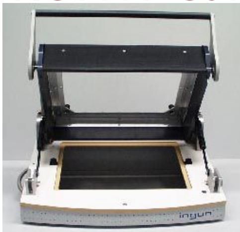
Все смонтированные электронные модули, подготовленные как своими силами, так и силами смежников, проходят внутрисхемный контроль. Проверяется не только работоспособность изделия в целом, но и каждый элемент электронной схемы отдельно, а также качество соединения между элементами.
