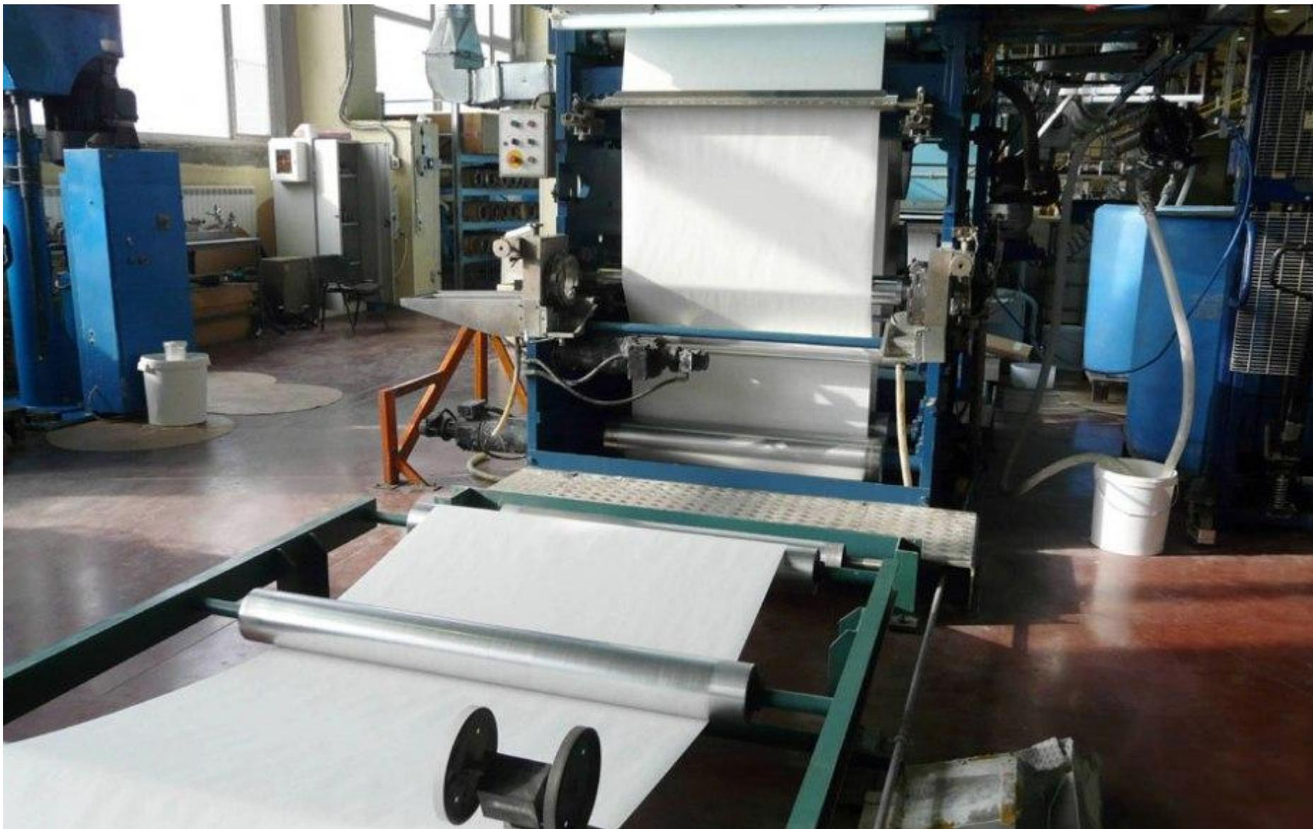
**Бумага, покрытая слоем винила, сушится в накопителе на линии нанесения PVC**
