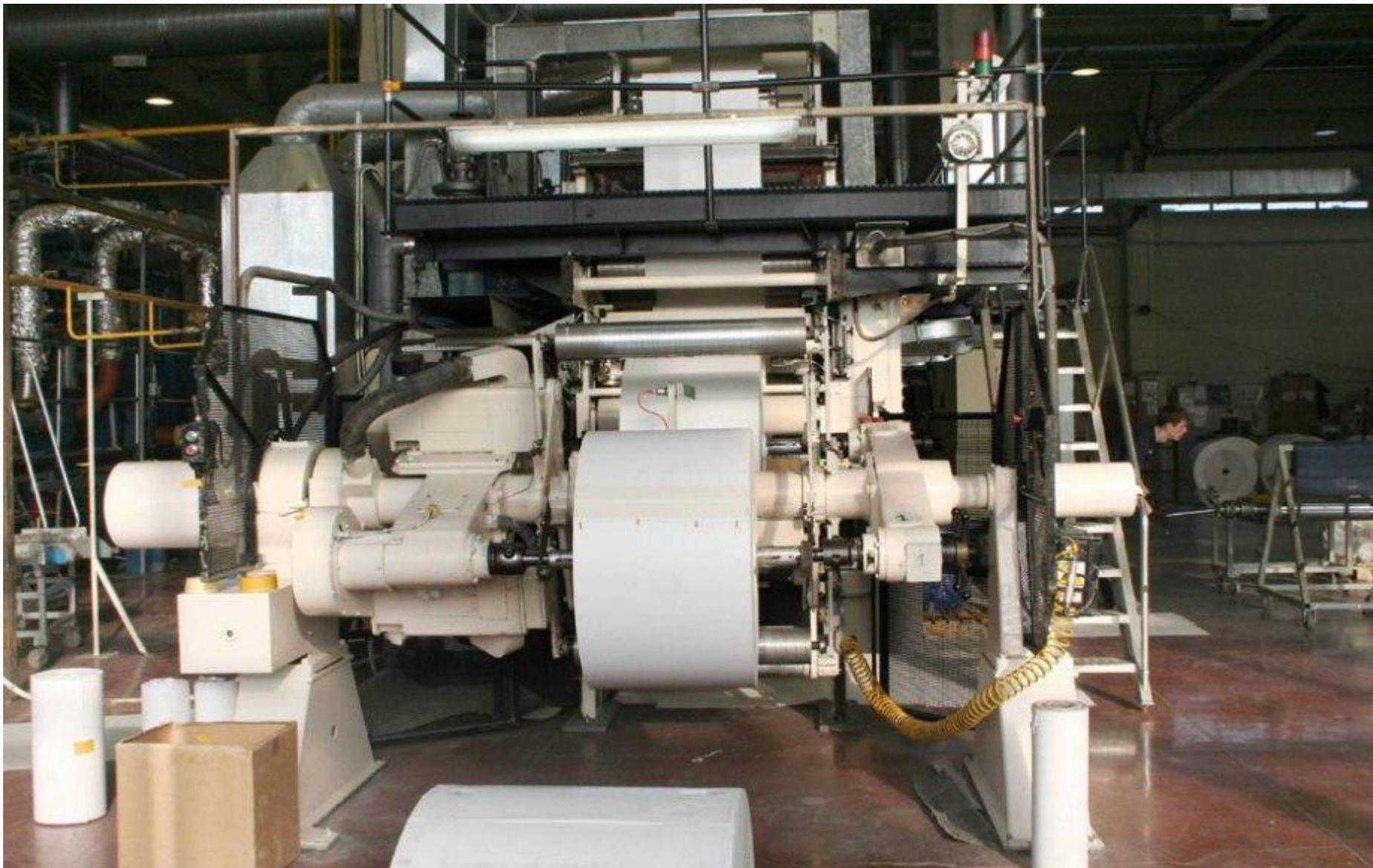
**Печатная линия: здесь происходит нанесение рисунка на виниловый прокат с помощью печатных валов**
