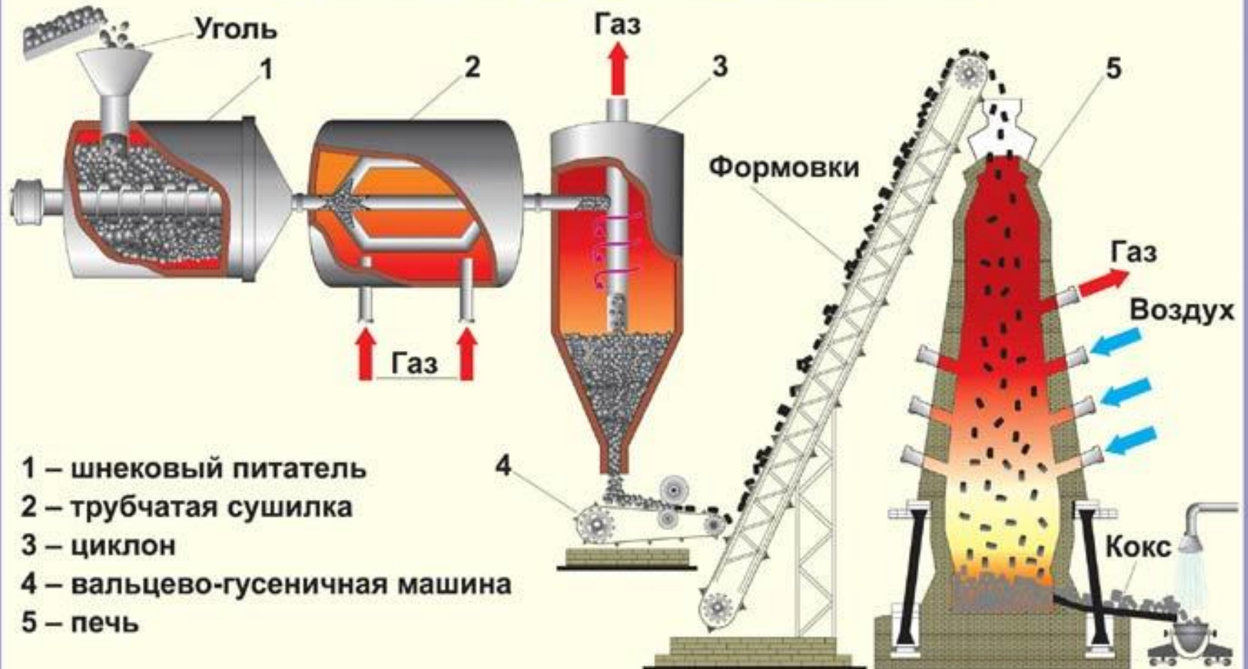
СХЕМА НЕПРЕРЫВНОГО КОКСОВАНИЯ УГЛЯ
