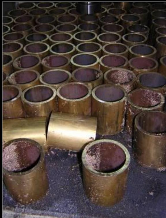
Корпус вырезается и фрезеруется до установленного размера
