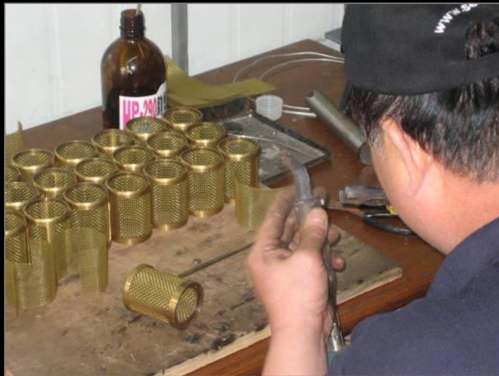
Производство сетей голов микрофонов
