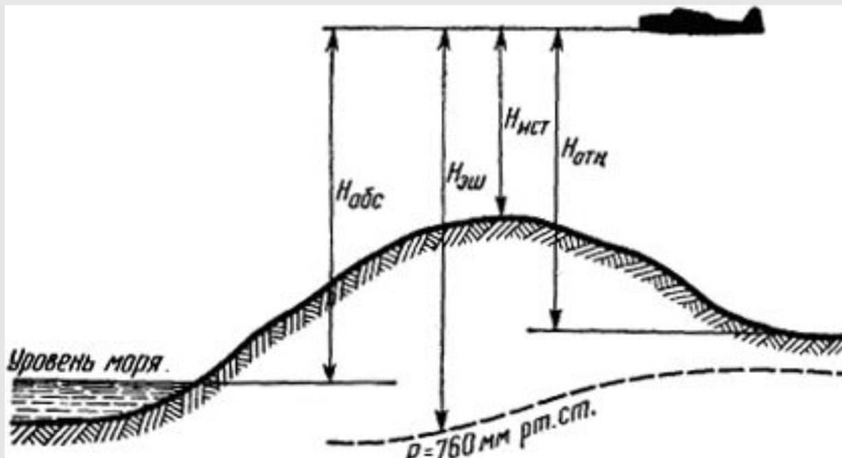
Для измерения высоты используют альтиметры или высотомеры. По принципу устройства высотомеры делятся на барометрические и радиотехнические.
