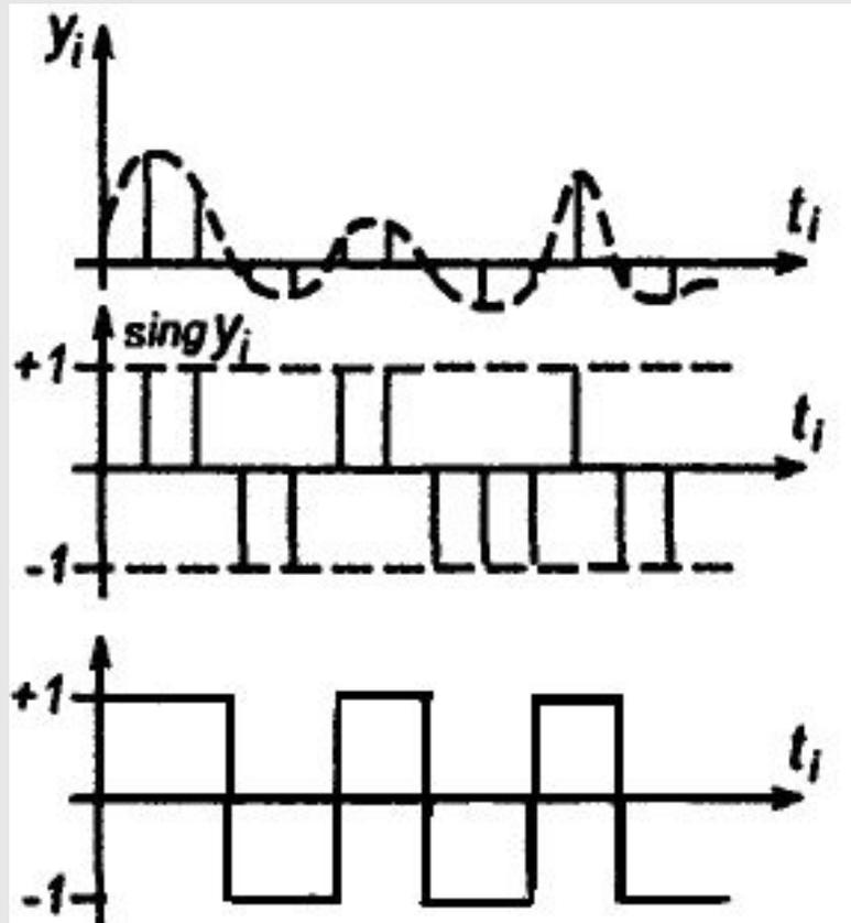
Преобразование синусоидального сигнала от генератора и приемника в двоичное представление.
