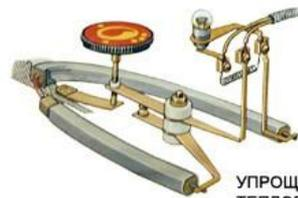
УПРОЩЕННАЯ СХЕМА ТЕПЛОГО РЕЛЕ
