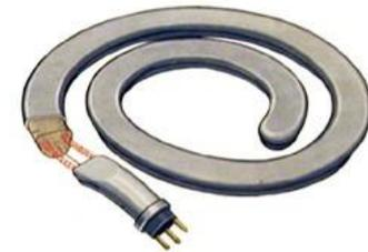
СХЕМА СОЕДИНЕНИЯ СПИРАЛЕЙ В ТРУБЧАТОМ НАГРЕВАТЕЛЬНОМ ЭЛЕМЕНТЕ
