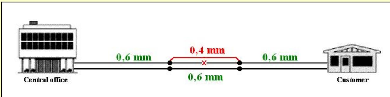
**Емкостная асимметрия** часто возникает после ремонта поврежденного провода.
