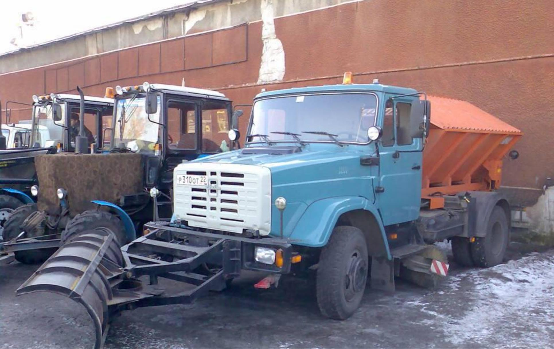
Комбинированная дорожная машина с отвалом, щеткой и пескораспределителем
