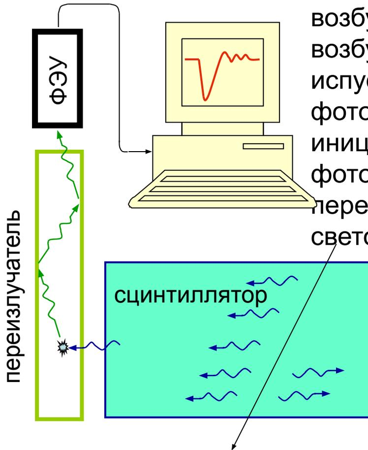
ФЭУ – фотоэлектронный умножитель. Это прибор для регистрации фотонов. Если на входное окно попадает фотон (лучше сотня фотонов), то на выходе появляется электрический импульс.
