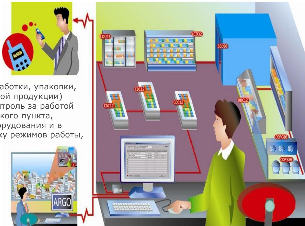
Параметры холодильных установок контролируемые ТАВ могут передаваться на центральный пульт, объединяющий несколько объектов с помощью программного обеспечения АRGO(псевдоним владельца компании LAE electronic) .
