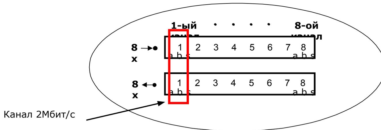
Линии приёма и передачи подключаются друг под другом на двух плинтах LSA-PROFIL 2/8xabs
