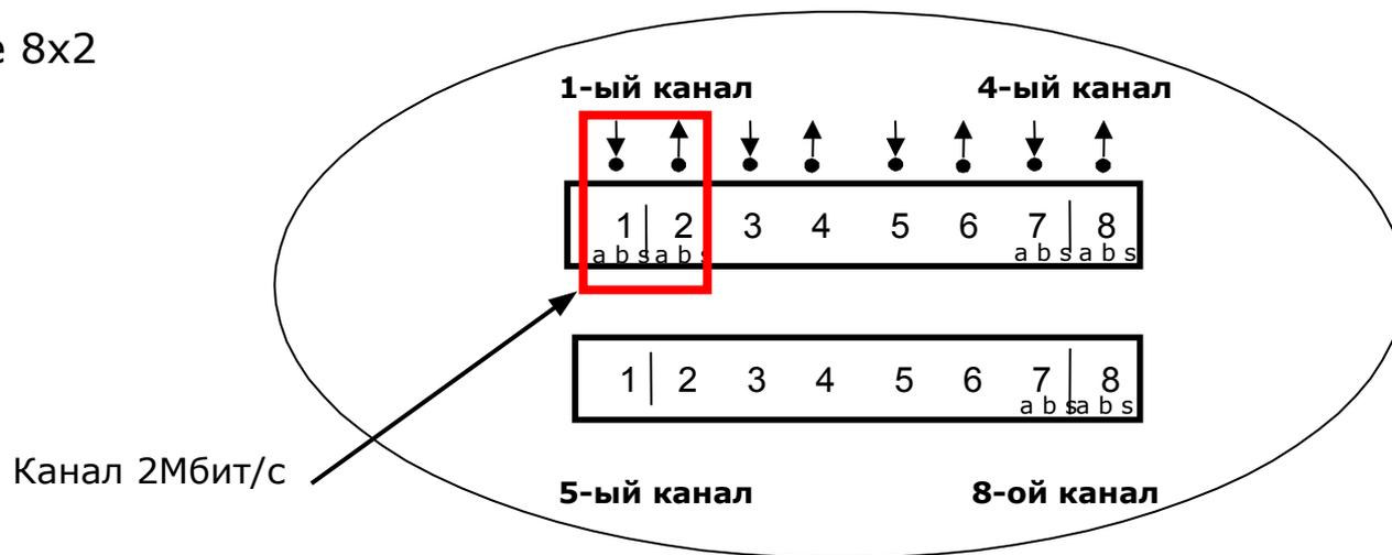
Линии приёма и передачи подключаются друг возле друга на одной плите LSA-PROFIL 2/8xabs
