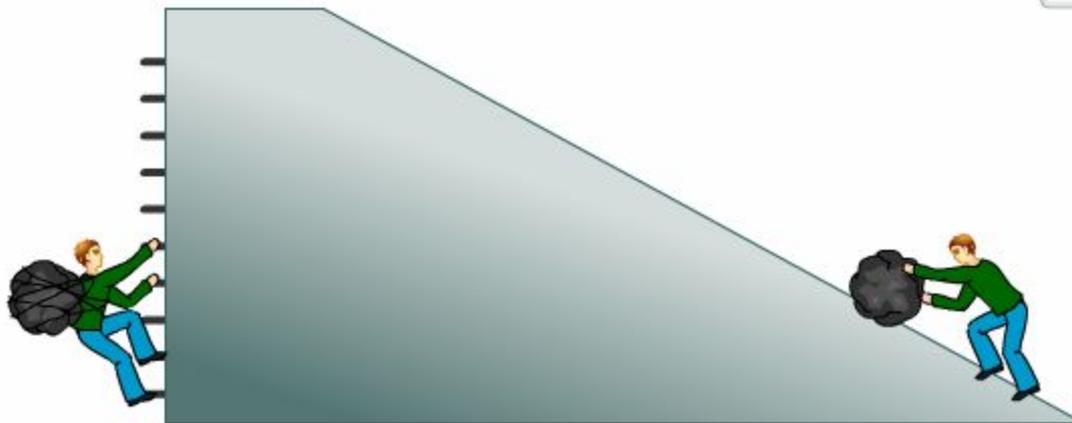
Модель 5.30. Поднятие груза по наклонной плоскости и без нее
