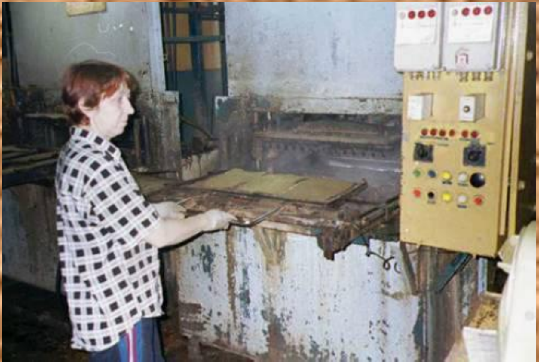
Производство прокладочных материалов из сфагнового мха и торфа в цехах ЗАО «Контакт» (г. Амурск)
