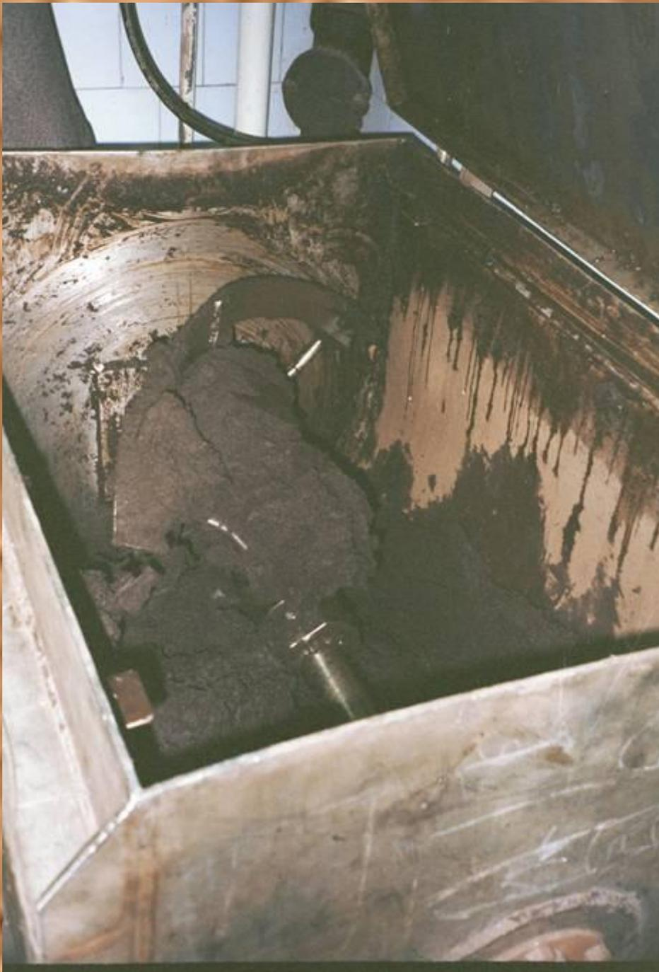
**Гомогенизатор с подогревом – устройство позволяющее придать нативному торфу заданные параметры влажности, липкости и пластичности.**
