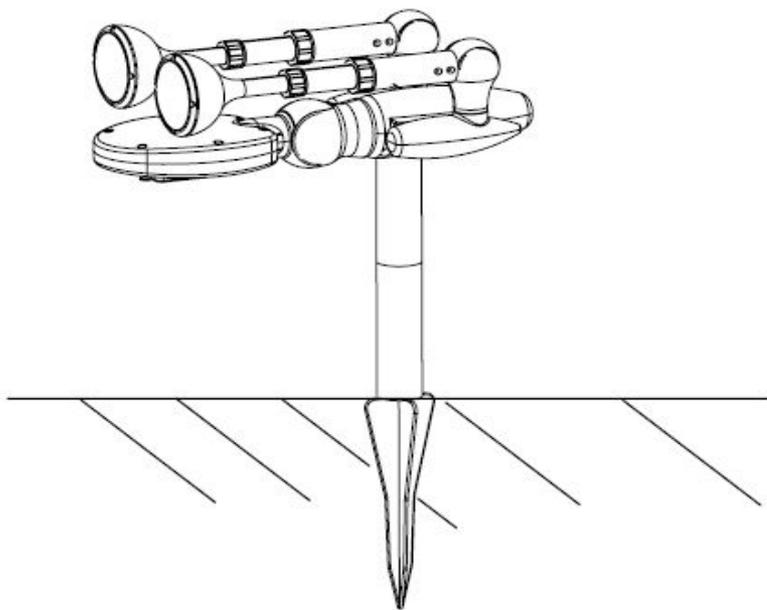
Рис. 3. Установка светильника на земле
